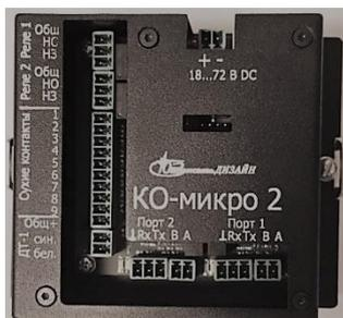
Контроллер КО-микро 2 предназначен для преобразования интерфейсов RS485/RS232 в интерфейс Ethernet, а также для контроля и управления оборудованием в системах мониторинга. Может использоваться как «удлинитель» интерфейсов. Имеет «прозрачную» передачу данных и протокол «КО». Последовательные порты гальванически развязаны между собой и питанием, что гарантирует дополнительную защиту оборудованию.
